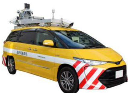
3次元点群データ計測車両
